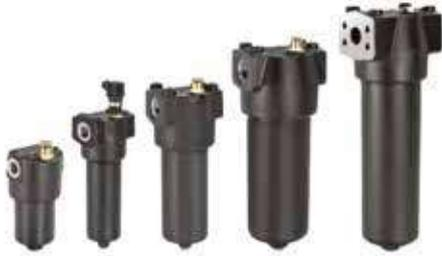
La serie EPF es un filtro de aceite hidráulico integrado, extremadamente compacto y respetuoso con el medio ambiente que presenta un núcleo de elemento reutilizable. Su capacidad de flujo máxima es de unos 700 l/min (185 GPM) Y su presión de funcionamiento máxima permitida es de 450 bares (6.500 psi).
